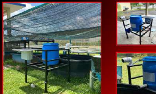
ALAT PEMBERIAN MAKANAN SECARA AUTOMATIK SOLAR BERKAMERA YANG DILETAKKAN PADA SISTEM AKUAPONIK
